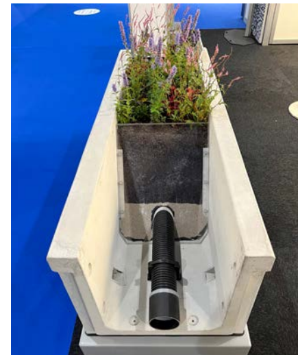
Mini Rain Garden: een bak van gewapend beton met planten erin, waarmee je hittestress tegengaat en water wordt gebufferd dat vervolgens gezuiverd vertraagd wordt afgevoerd.
